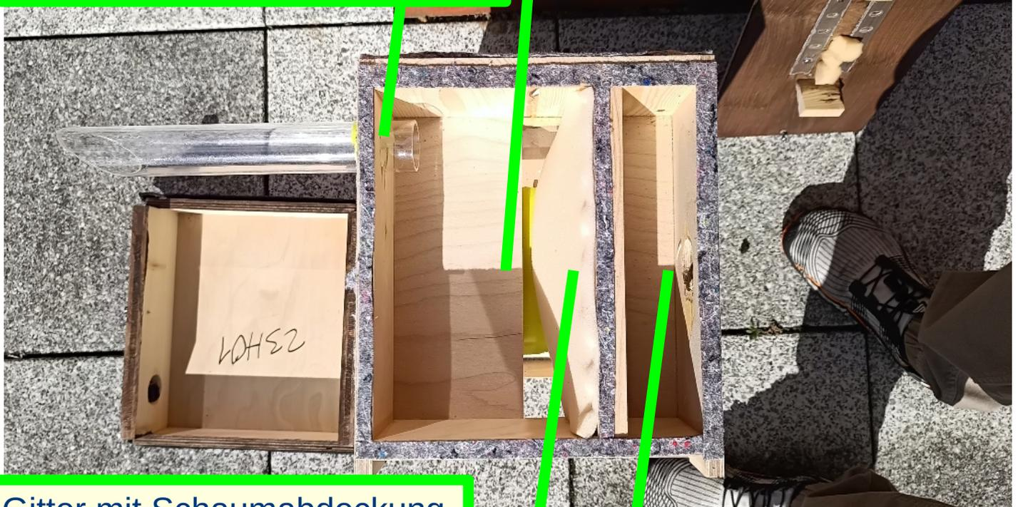
Gitter mit Schaumabdeckung damit die Hornissen nicht am Gitter verletzt werden. Die Oberkante ist durchgängig mit Filz abgedichtet, damit der Saugdruck nicht daneben verloren geht.
